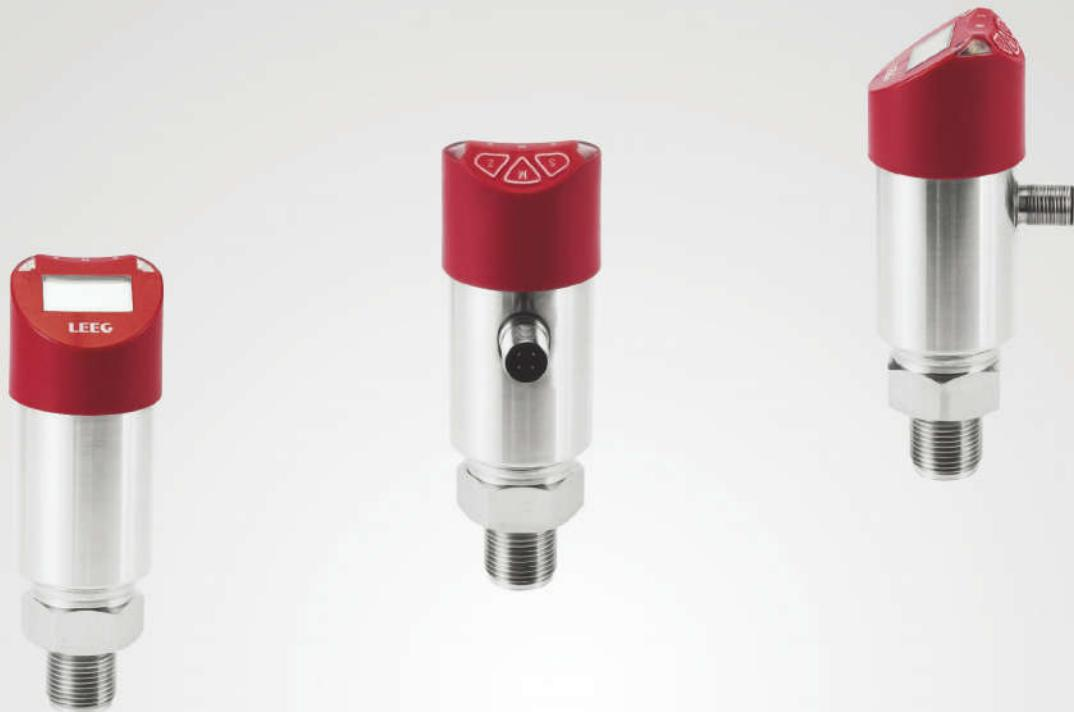
PS131电子压力开关秉承了立格仪表全面满足最恶劣使用场合的一贯设计理念，采用单晶硅传感器技术和一体成型外壳工艺，是一款超高性能的电子压力开关。PS131的5位点阵式OLED显示模式，可以显示丰富的菜单内容并达到了最佳的视觉效果；3按键参数设置，实现了良好的人机操作界面和丰富的功能调试；独立透气腔结构，对传感器导气端与电子腔室进行有效隔离，避免电子腔室受到湿度的影响。PS131可以根据运用工况，选配高过载、防冷凝、高精度等高要求功能，从而最大程度地满足各种工业场合的使用要求。
