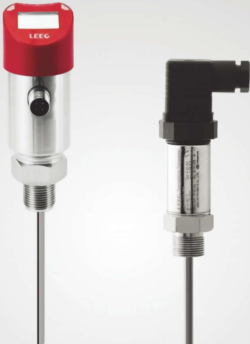
LG200温度变送器采用专用集成电路与表面封装技术的信号变送模块，并可选内置带背光和按键操作的LCD显示模块。一体化耐瞬变电压端子块，满足四级标准（差模电压：2000V，共模电压：4000V），适用于恶劣的浪涌电压场合。LG200温度变送器为任何温度测量工况提供了一个灵活、可靠的解决方案。
