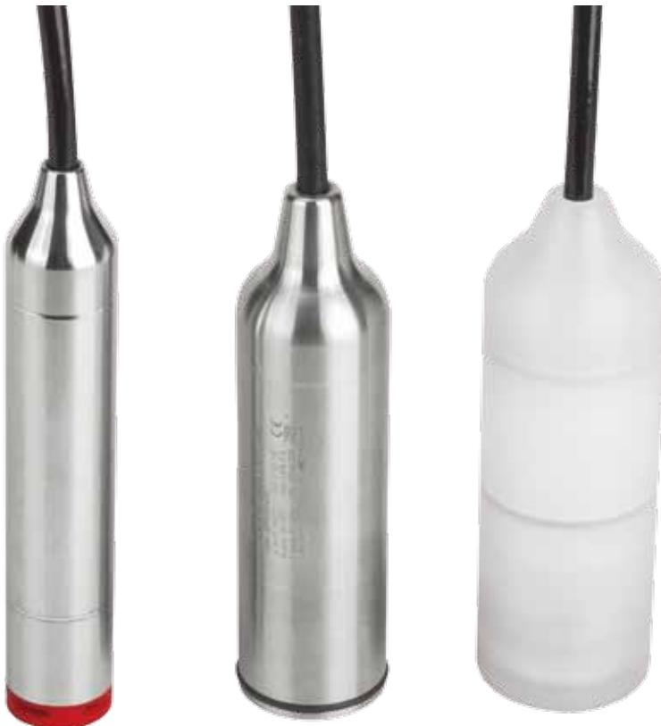
LEEG投入型单晶硅压力变送器是为了应对苛刻的液位测量工况而设计。传感器采用了先进的微处理技术进行了全方位线性误差和温度误差补偿，确保测量结果达到高准确度要求；投入探头采用了全灌封防冷凝技术，安全可靠的双密封设计，全焊接工艺以及坚固的不锈钢外壳，确保产品的长期可靠性以及永久气密性；信号变送模块采用了耐瞬变电压保护电路，确保即使在苛刻的浪涌电压环境中仍可运行自如；线缆密封采用了加强的锥堵密封工艺，确保即使在安装和长期使用中受到较大的机械负载时也具有长久的使用寿命。LEEG投入型单晶硅压力变送器是一款满足所有高要求的液位测量应用的选择。
